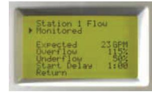
Durchflussaufzeichnung- und kontrolle mit einem Knopfdruck. Die Durchflussaufzeichnung kann pro Station programmiert werden.
