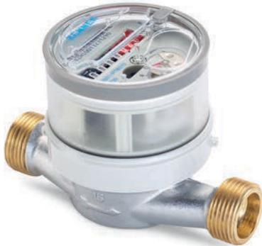
Für heutige und künftige Smart-Metering-Anwendungen, die eine Fernauslesbarkeit der Zähler voraussetzen, wurde ein Modell mit elektronisch und rückwirkungsfrei abtastbarer Modulatorscheibe entwickelt (ETKD-M/ ETWD-M). Die Möglichkeit der elektronischen Abtastung der Modulatorscheibe ist die Basis für die Fernauslesung der Zählerdaten per Funk, M-Bus oder Impuls. Durch Nachrüstung unseres EDC-Moduls wird aus dem Einstrahlzähler mit wenigen Handgriffen ein zukunfts-sicherer Smart-Water-Meter.
